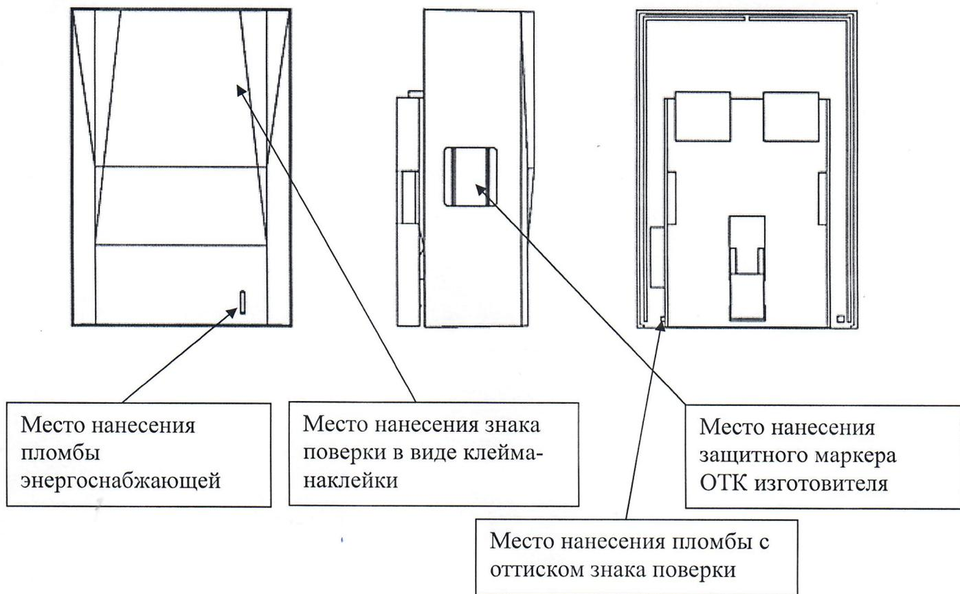
Рисунок А.2 – Места установки пломб и нанесения знака поверки для счетчиков в корпусе модификации SP2.
