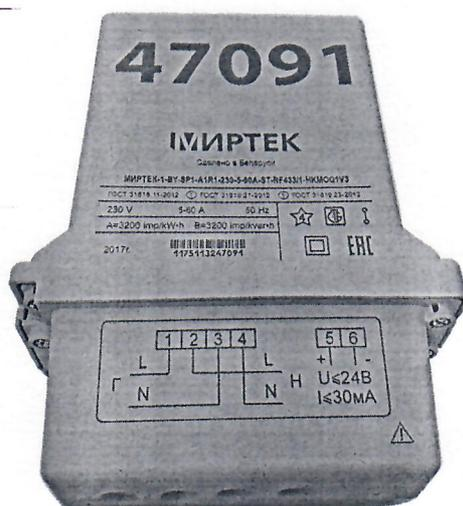
Рисунок 2 – Внешний вид счетчика в корпусе модификации SP1
